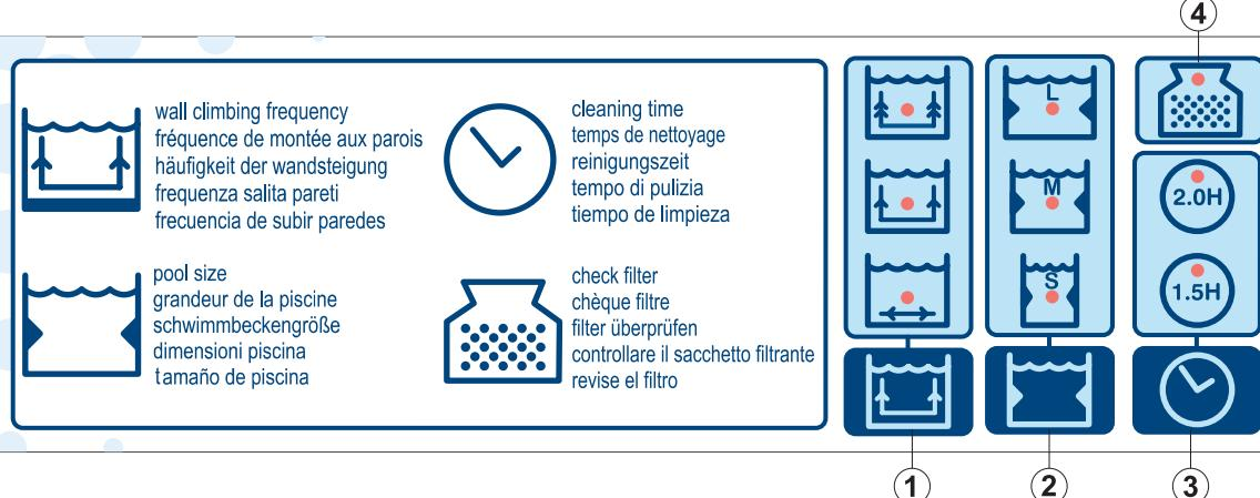
Aquacontrol is een uniek bedieningspaneel waarmee u direct met de robot kunt communiceren en hem aanpassen. Met dit menselijke interface apparaat kunt u verschillende parameters programmeren, zodat het zwembad altijd zo efficiënt mogelijk schoongemaakt kan worden. Kies de best passende functies waardoor uw robot een maximum levensduur heeft. Als u liever geen functies selecteert kan de robot in de standaard modus werken waarin hij zelf de parameters voor u uitkiest.
