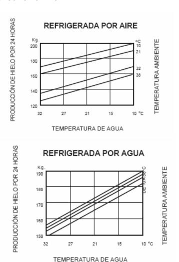
**NOTE:** The daily production capacity change when the environmental temperature and the water supply change, a capacidad de producción diaria varía al variar la temperatura ambiente y del agua de alimentación , thus the space around the equipment..
