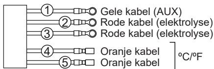
De gasstroomsensor op het apparaat aansluiten.
