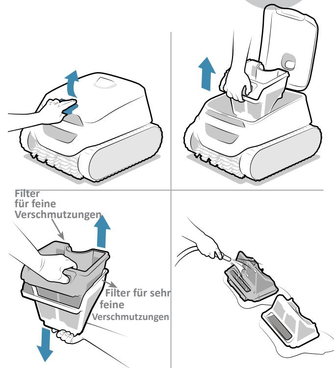
1 Öffnen. Filter entfernen.
