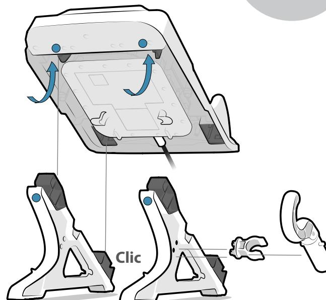
1 Deslizar la parte superior del pie (círculo azul) bajo la base de la estación (círculo azul) y luego sujetar la parte inferior del pie.
