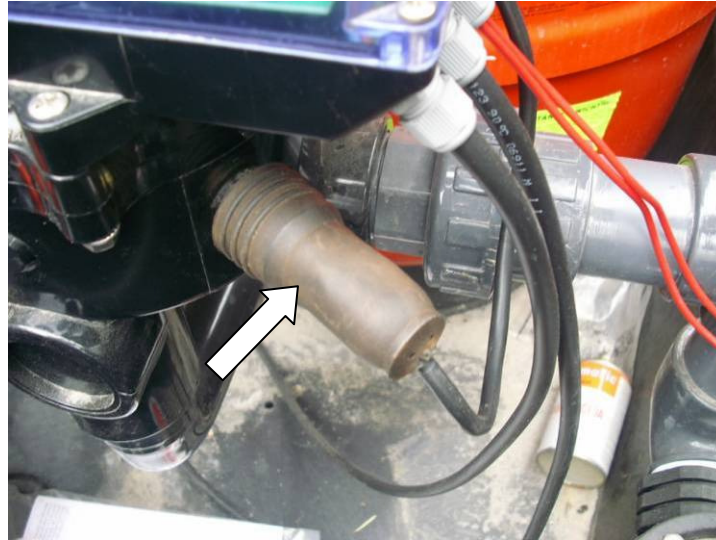
Fig. 20.- Presostato de la válvula Basic .
