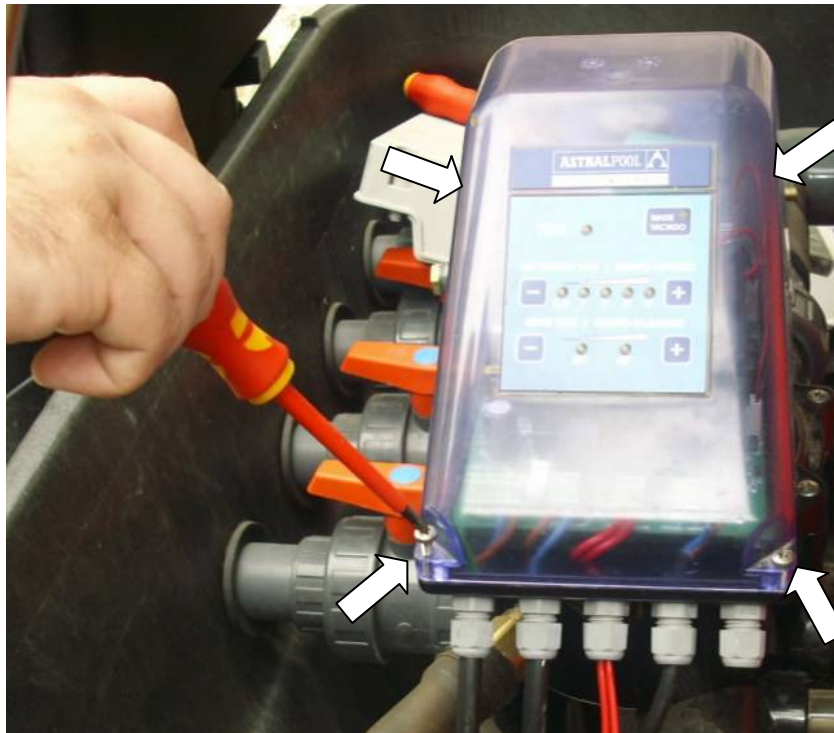
Fig. 1.- Desenroscar los 4 tornillos que sujetan la tapa-caratula
