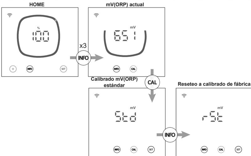
Desde el menú de calibrado de mV(ORP), el equipo nos permite realizar un calibrado estándar o resetear el calibrado actual a valores de fábrica:
