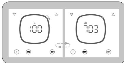
3. Modelo Ei2 iQ evo pH/ORP: Alterna cíclicamente entre producción actual (%), pH y ORP (mV) de la piscina.
