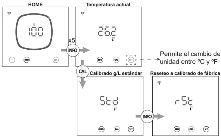
Desde el menú de calibrado de temperatura, el equipo nos permite realizar un calibrado estándar o resetear el calibrado actual a valores de fábrica:
