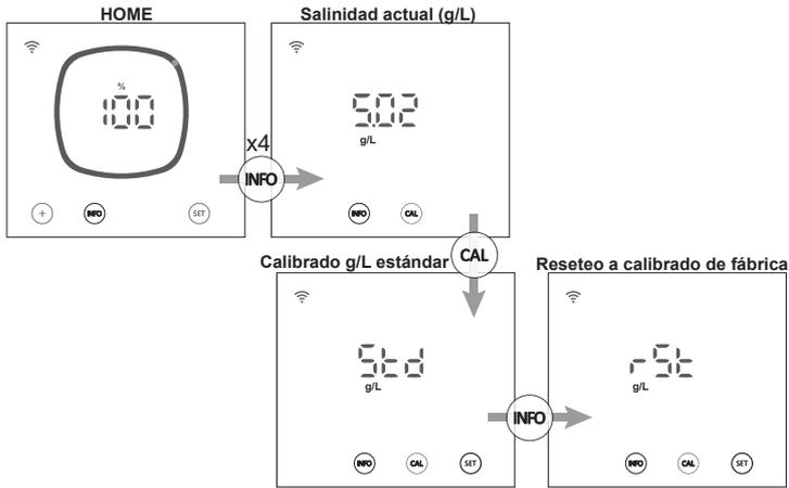
Desde el menú de calibrado de salinidad, el equipo nos permite realizar un calibrado estándar o resetear el calibrado actual a valores de fábrica:
