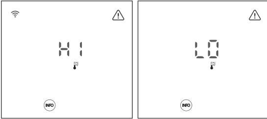
La alarma de temperatura aparecerá cuando los valores de temperatura estén fuera del rango configurado por el usuario.
