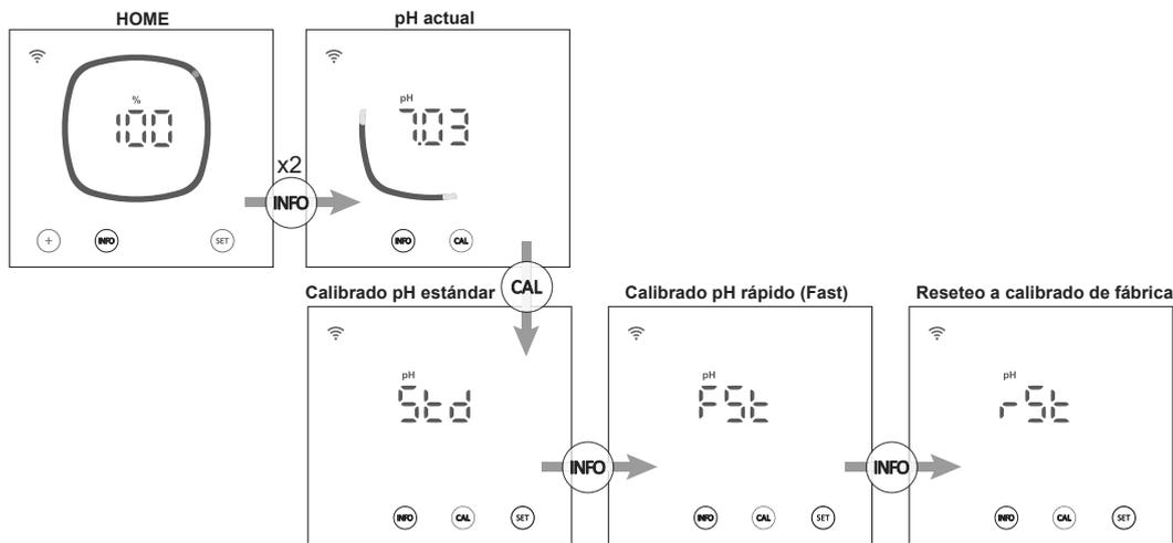
Desde el menú de calibrado de pH, el equipo nos permite realizar un calibrado estándar, un calibrado rápido (fast) o resetear el calibrado actual a valores de fábrica:
