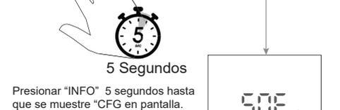
Presionar “INFO” 5 segundos hasta que se muestre “CFG en pantalla.
