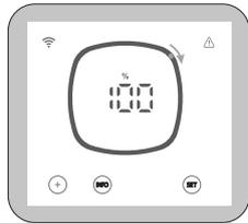
2. Modelo Ei2 iQ evo pH: Alterna cíclicamente entre producción actual (%) y pH de la piscina.
