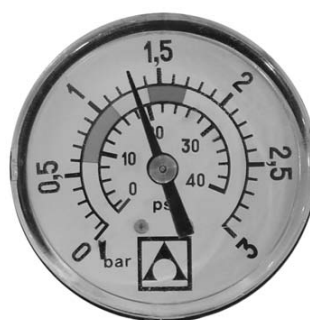
1,3 kg/cm 2 - 18,5 PSI: Esta pressão indica que é necessário proceder á lavagem "Lavado".
