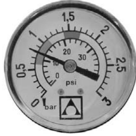
0,8 kg/cm 2 - 11,4 PSI: filitreleme sürecinin başındaki normal basınç
