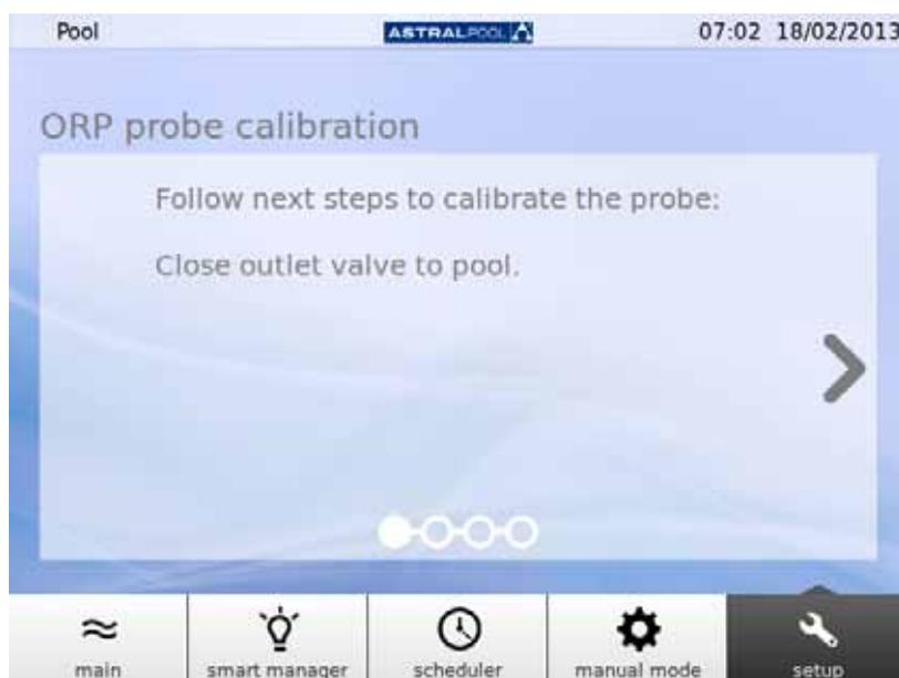
Abbildung 33: Schließen Sie das Auslassventil zum Pool.
