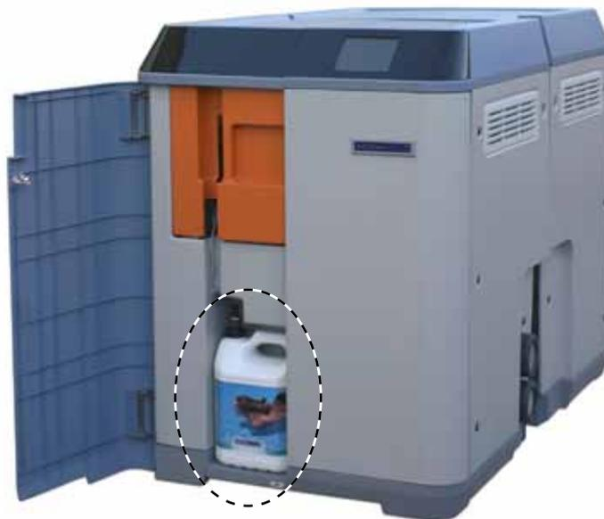
Abbildung 38: pH-Reduktionsmittelflasche
