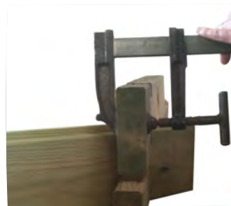
Redirected board • Tabla redirigida • Madrier redressé • neu ausgerichtetes Brett • Tavola riposizionata • Rechtgebogen plank • Tábu redirigida
