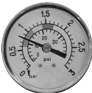
0,8 kg/cm 2 - 11,4 PSI: Normaldruck bei Beginn des Filtriervorganges.
