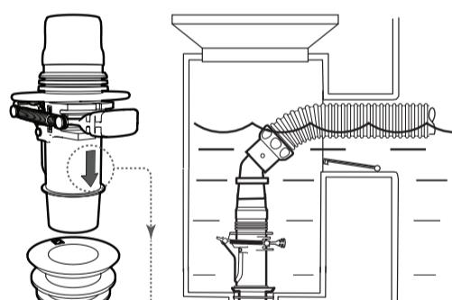
> Install with Arrow Down > Installez avec flèche vers le bas > Instale con Flecha Abajo > Installare con Freccia Giù > Installation mit Pfeil nach unten > instalar com seta para baixo > installeren met pijl naar beneden > Umísteť šípkou směrem dolů > Nainstalujte šípkou smerom nadol > Zainstalować w taki sposób, aby strzałka była skierowana do dolu > Установите так, чтобы стрелка указывала вниз > Aşağı oka göre monte edin > Instalirajte sa strelicom prema dolje
