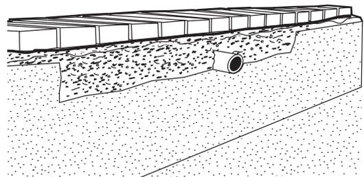
Nach der Überprüfung des Systems die entsprechenden Einbauteile verwenden, um die Einlaufkanäle des Wasserfalls mit den Rohrleitungen zu verbinden. Kein Drehmoment auf die Einbauteile der Einlaufkanäle anwenden.
