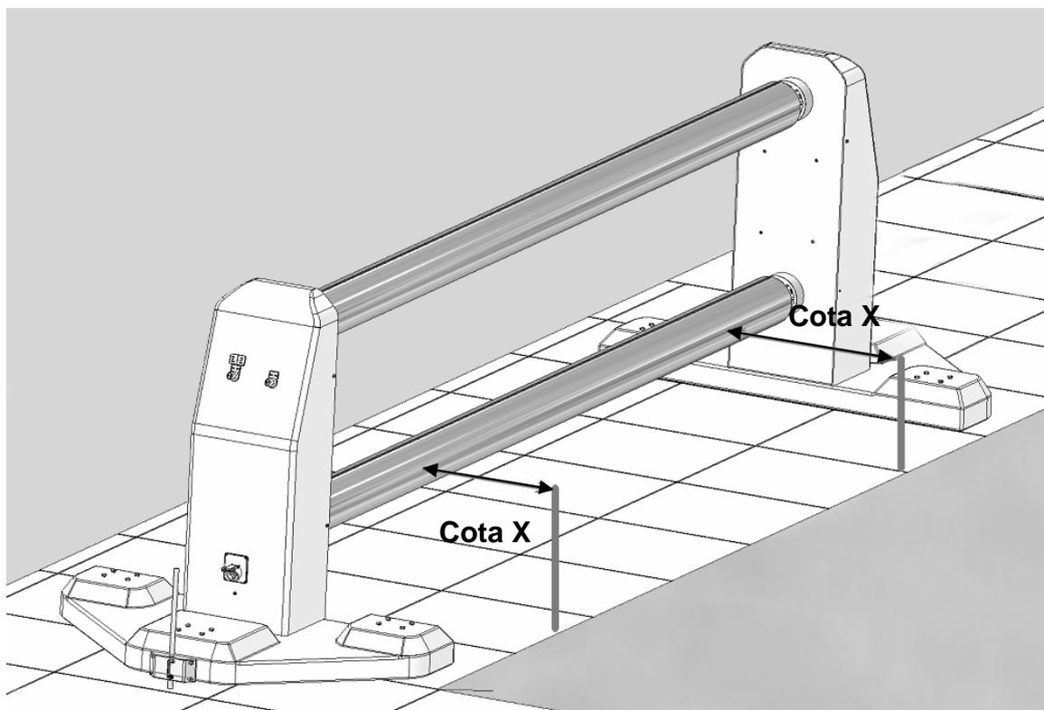
Una vez el enrollado posicionado, hacer una marca en el suelo, al nivel del dispositivo de centrage de cada lado. Después taladrar  $\text{Ø}16\text{mm}$  en 50mm de profundidad.
