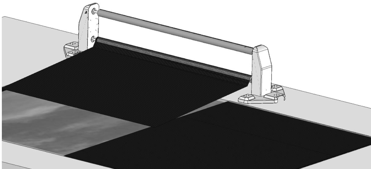
Posicionarse delante la primera cubierta. Enganchar las cintas de fijación en el eje de enrollamiento 1 (el sistema de fijación es definido por el constructor de la cubierta). Colocar el selector en « eje de abajo». Después enrollar la cubierta.
