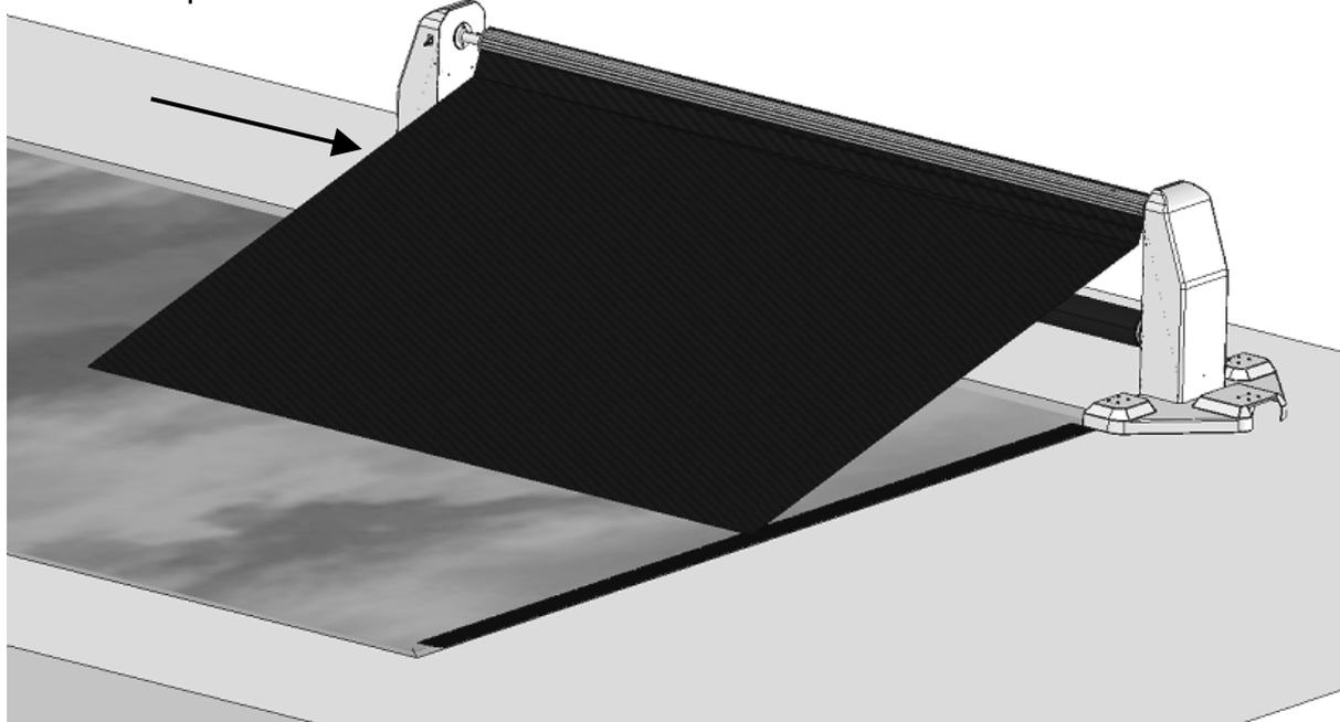
**Cuidado:** Encerrar el soporte móvil sobre cada enrollamiento para evitar que el enrollado mueva y descentre el enrollamiento de la cubierta.
