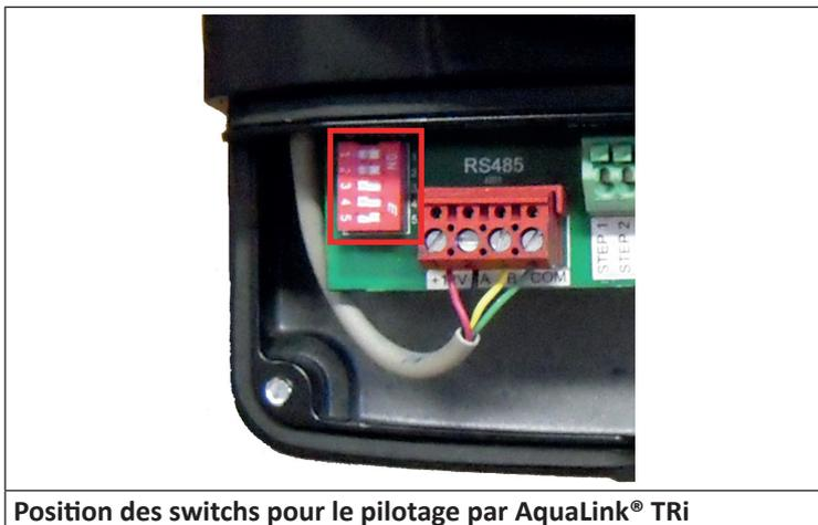
Position des switchs pour le pilotage par AquaLink® TRI
