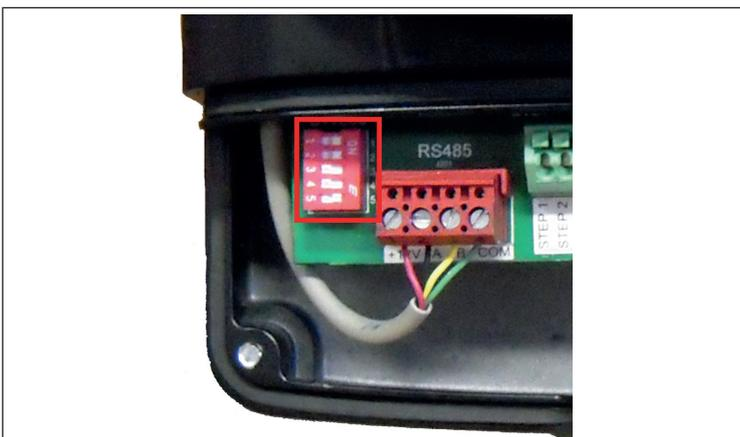
Position des switchs pour le pilotage par l'interface utilisateur
