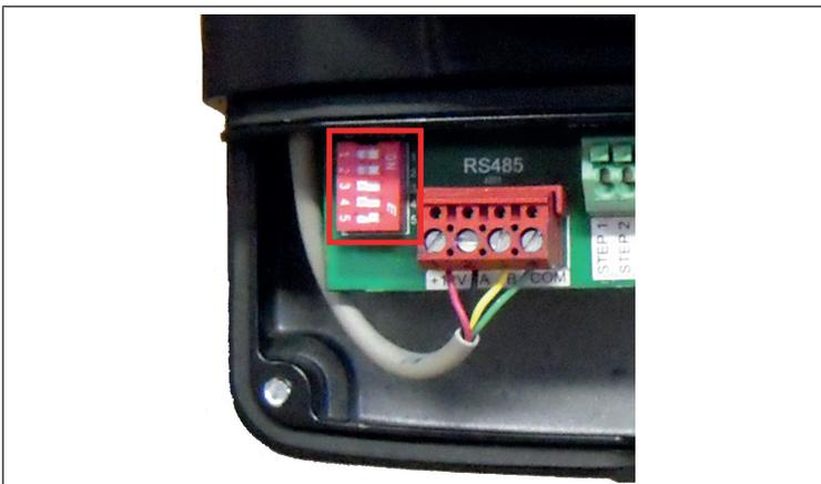
Position des switchs pour le pilotage par iQPUMP
