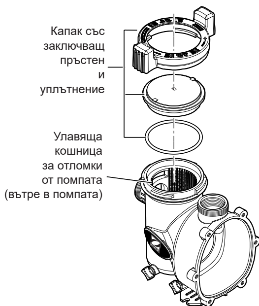
ФИГУРА 7 – СХЕМАТИЧЕН ЧЕРТЕЖ НА СБОРКАТА НА КАПАКА
