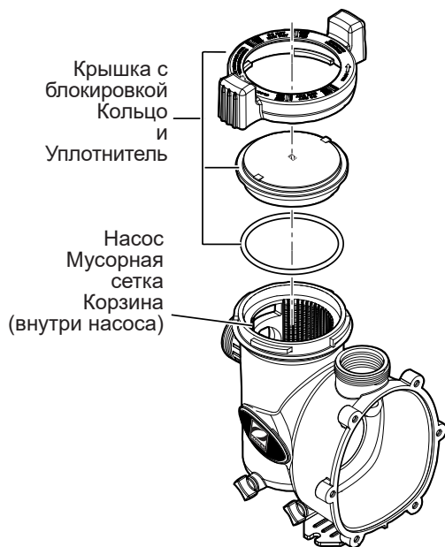
РИСУНОК 7 - ДЕТАЛЬНЫЙ ВИД КРЫШКИ В СОБРЕ
