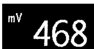
**FR** Appuyer pendant 3 secondes sur le bouton CAL, la valeur 468 commencera à clignoter sur le Display. L'étalonnage est fait automatiquement et il se termine quand la valeur sur le Display redevient fixe.
