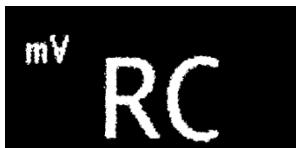
**FR** Si à la fin de l'étalonnage le display affiche "rc", appuyer sur le bouton Cal pour revenir à la lecture. Répéter la procédure d'étalonnage, si le message "rc" réapparaît, cela signifie que l'électrode n'est pas en bon état et qu'elle doit être changé.
