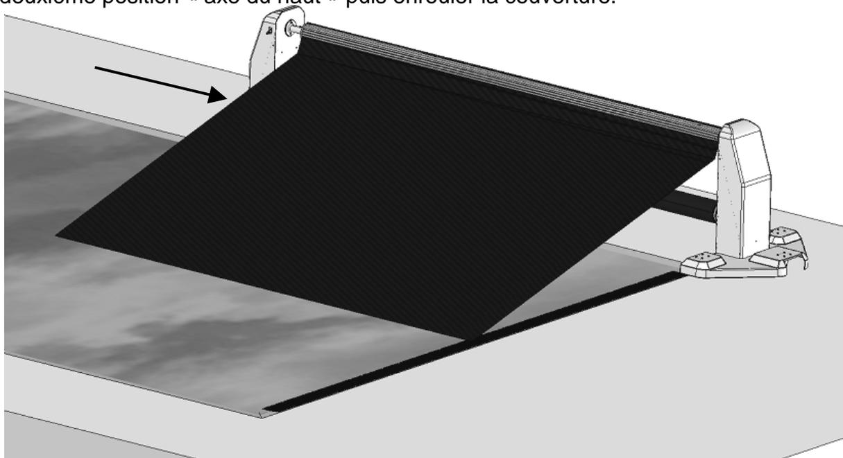
**Attention :** Verrouiller le support mobile sur chaque enroulement pour éviter que l'enrouleur ne bouge et ne désaxe l'enroulement de la couverture.
