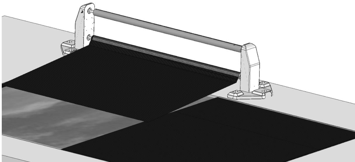
Se positionner devant le premier lé de couverture. Accrocher les sangles d'accrochage à l'axe d'enroulement 1 (le système d'accrochage est défini par le constructeur de la couverture). Positionner le sélecteur sur « axe du bas ». Puis enrouler la couverture.
