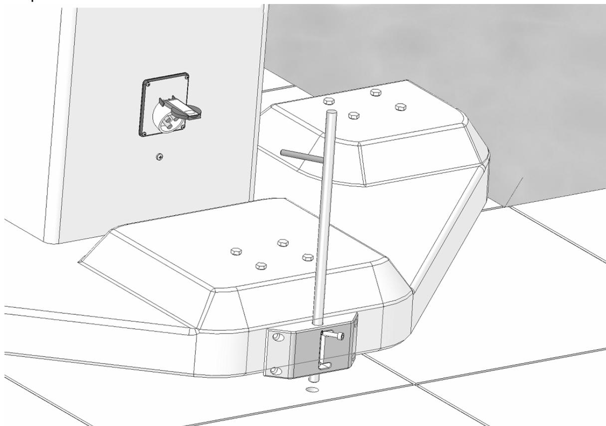
Puis verrouiller en manipulant le système de verrouillage avant toute utilisation d'enroulement de la couverture.
