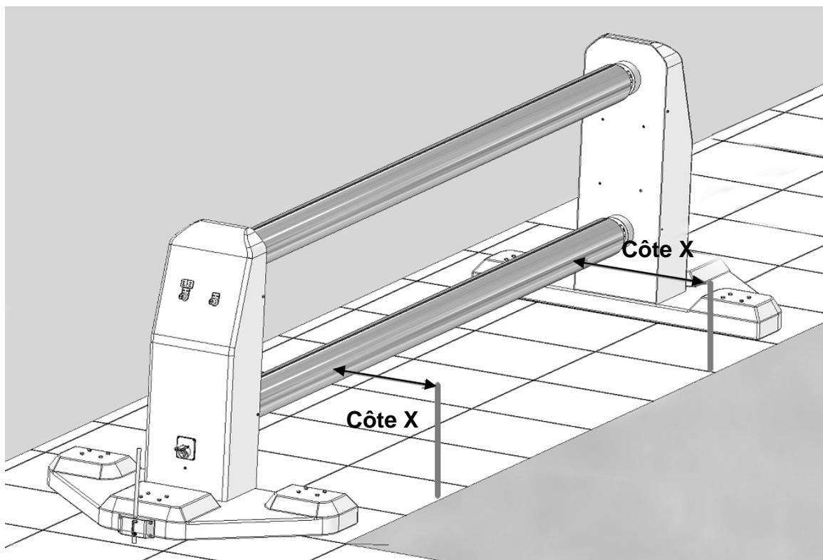
Une fois l'enrouleur positionné, réaliser un repérage au sol, au niveau du dispositif d'indexage de l'enrouleur sur chaque côté. Puis percer à  $\text{Ø}16\text{mm}$  sur 50mm de profondeur.
