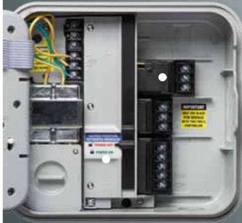
La unidad básica de 3 estaciones llega a ampliarse a 15 estaciones con los módulos PCM.
