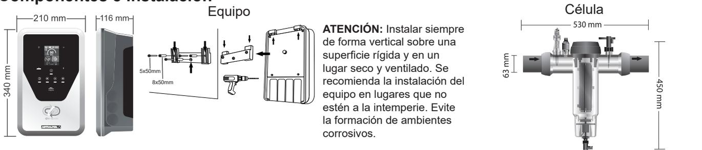
**ATENCIÓN:** Instalar siempre de forma vertical sobre una superficie rígida y en un lugar seco y ventilado. Se recomienda la instalación del equipo en lugares que no estén a la intemperie. Evite la formación de ambientes corrosivos.
