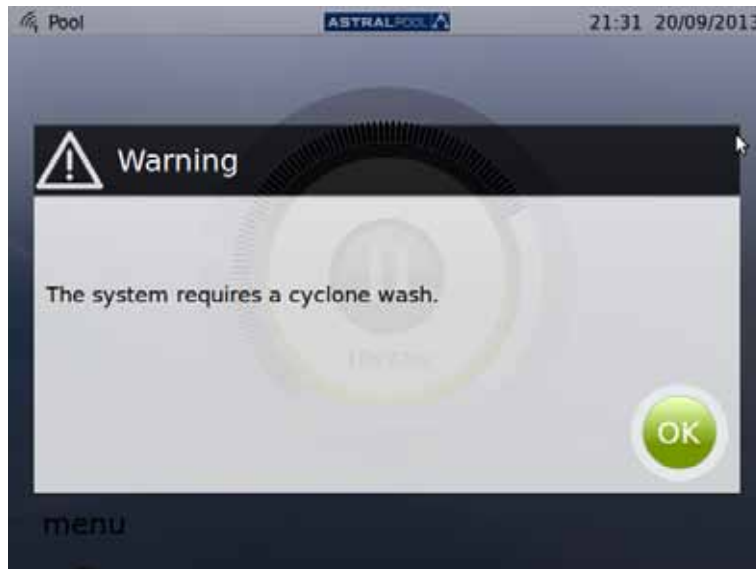
Figura 44: O ciclone necessita de ser lavado
