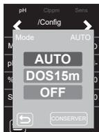
**pH-** : établit le pH du produit qui va être utilisé. Lorsque l'électrolyse est activée, la valeur pH- ne peut pas être modifiée. 🔒
