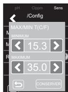
**MAX/MIN T(C/F) :** établit la valeur maximale/minimale de l'alarme de température. En fonction de ces valeurs, l'appareil affichera l'alarme de température.
