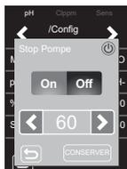
**Stop Pompe** : Le contrôleur de pH intègre un système de sécurité, la **FONCTION STOP POMPE**, qui agit sur la pompe de dosage afin d'éviter les situations suivantes :
