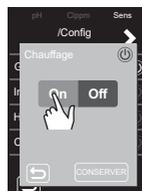
**Chauffage :** il s'active automatiquement pour maintenir la température de l'eau souhaitée. La température peut être réglée dans une plage comprise entre 6 °C et 50 °C.
