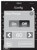
**Stop Pompe** : Le contrôleur de CimV/Clppm intègre un système de sécurité, la  **FONCTION STOP POMPE**, qui agit sur la pompe de dosage afin d'éviter les situations suivantes :
