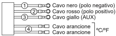
**Collegamento del sensore paletta (flussostato) alla scheda principale.**
