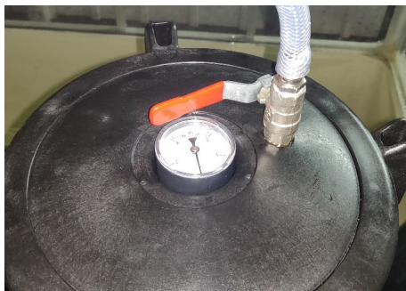
Figure 13 - Vanne quart de tour + tuyaux préconisés à la place de la vis de purge
