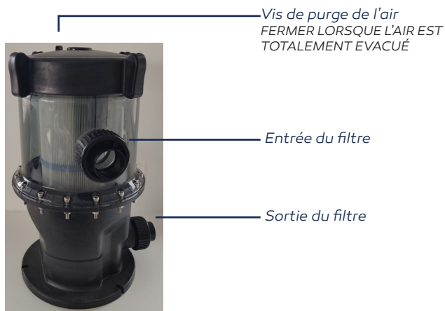
Figure 1 – Entrée, sortie et vis de purge d'air du filtre à cartouche
