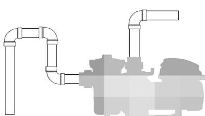
Errata: possibile aria nelle tubazioni, rischi di riempimento incompleto del prefiltra.
