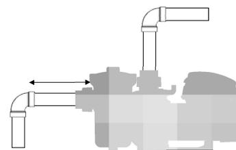
Corretta: La lunghezza del tubo d'aspirazione = 4 x diametro del tubo (20 cm per DN50 e 25 cm per DN63).
