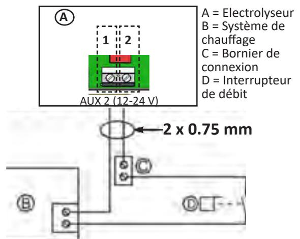
Raccordement d'un système de chauffage sans commande marche/ arrêt à distance
