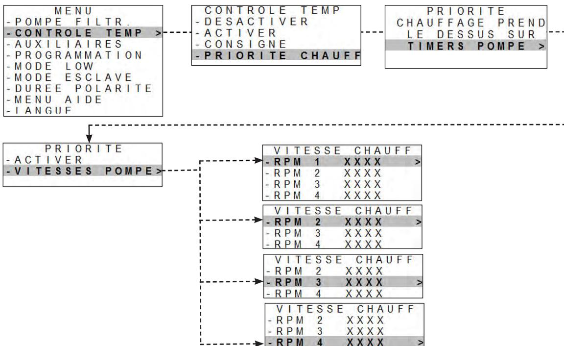
**i** - Si une pompe de filtration est déclarée et que la priorité chauffage est activée en dehors des timers de filtration : la filtration fonctionnera pendant 5 minutes toutes les 120 minutes dans le but de mesurer la température de l’eau.
