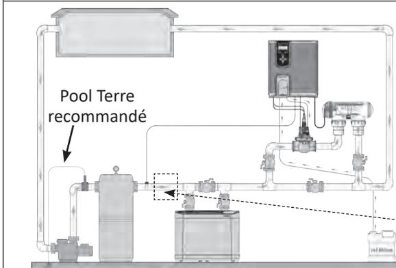
Installation avec un système de chauffage
