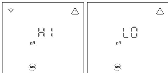
L'allarme di salinità appare quando i valori di g/L non rientrano nei valori configurati.
