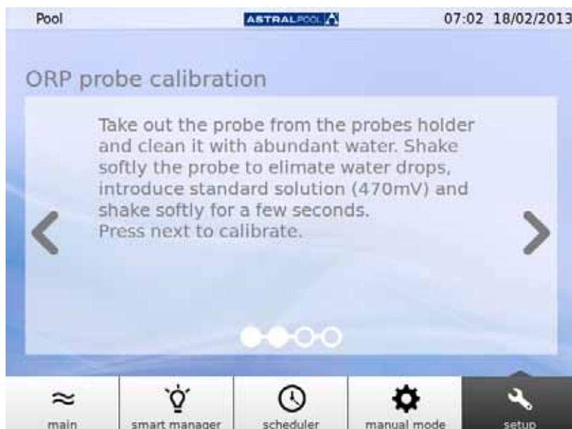
Figure 34 : Versez une solution standard
