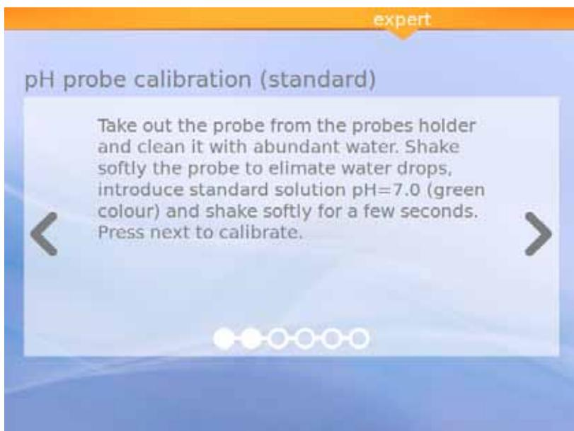
Figure 28 : Solution standard (verte)
