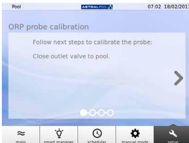
Figure 33 : Fermez la vanne de sortie de la piscine
