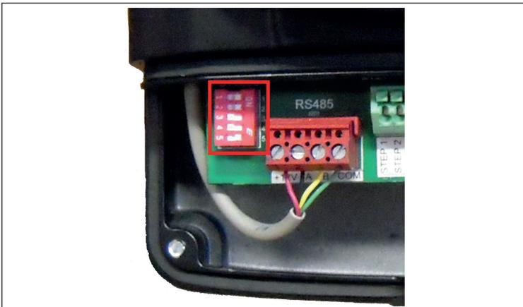
Posición de los conmutadores para el pilotaje mediante AquaLink® TRi
