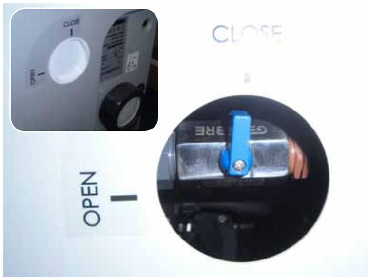
Рисунок 47: Откройте крышку и установите ручку в положение "Открыто".
