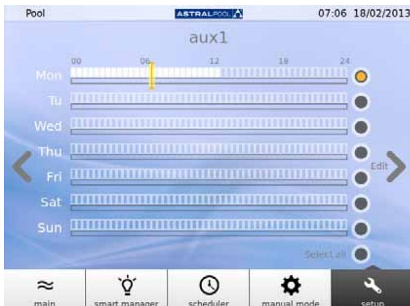
Рисунок 20: Планировщик дополнительных устройств
