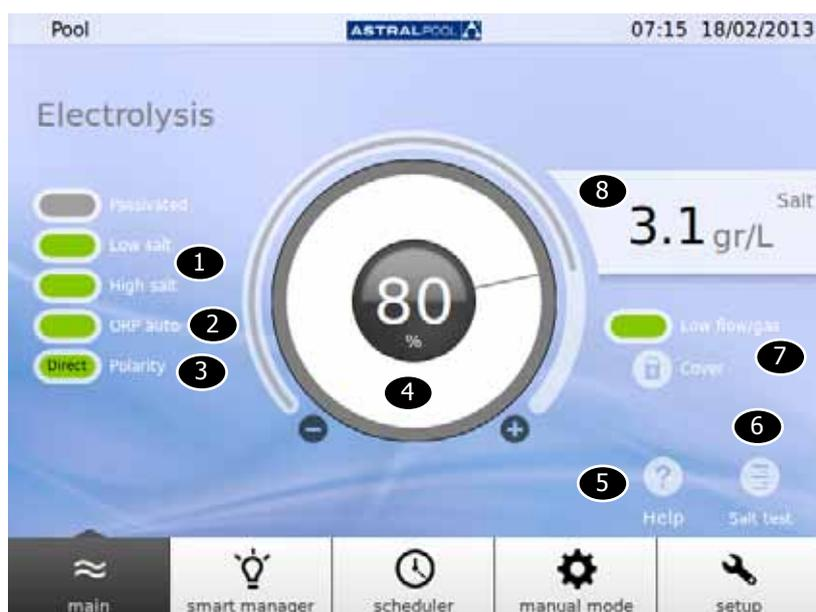
Рисунок 17: Настройка электролиза
