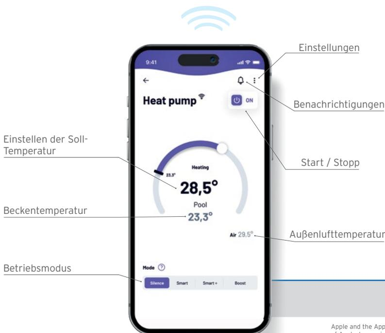
Sie Smartphone-App **Fluidra Pool®** verbindet die **Wärmepumpe Z650iQ** mit all Ihren Schwimmpreferenzen: verfügbare Betriebsmodi **nutzen, konfigurieren und anzeigen**. Sie können auch den Energieverbrauch verfolgen.
