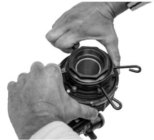
2. Para el funcionamiento a 360°, retire los dos anillos de ajuste.
