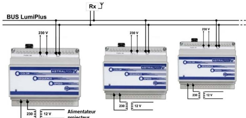
**Le maximum de modulateurs pouvant être synchronisés est au nombre de 10 et le maximum d'antennes que vous pouvez poser dans une même installation pour avoir un maximum de couverture est au nombre de 3.**
