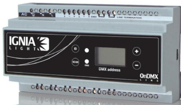
▼ Per un controllo totale dei proiettori RGB - DMX in un ambiente con protocollo DMX, è necessario collegare i proiettori all'alimentatore DMX. Disponibile con sorgente di alimentazione interna o esterna.
