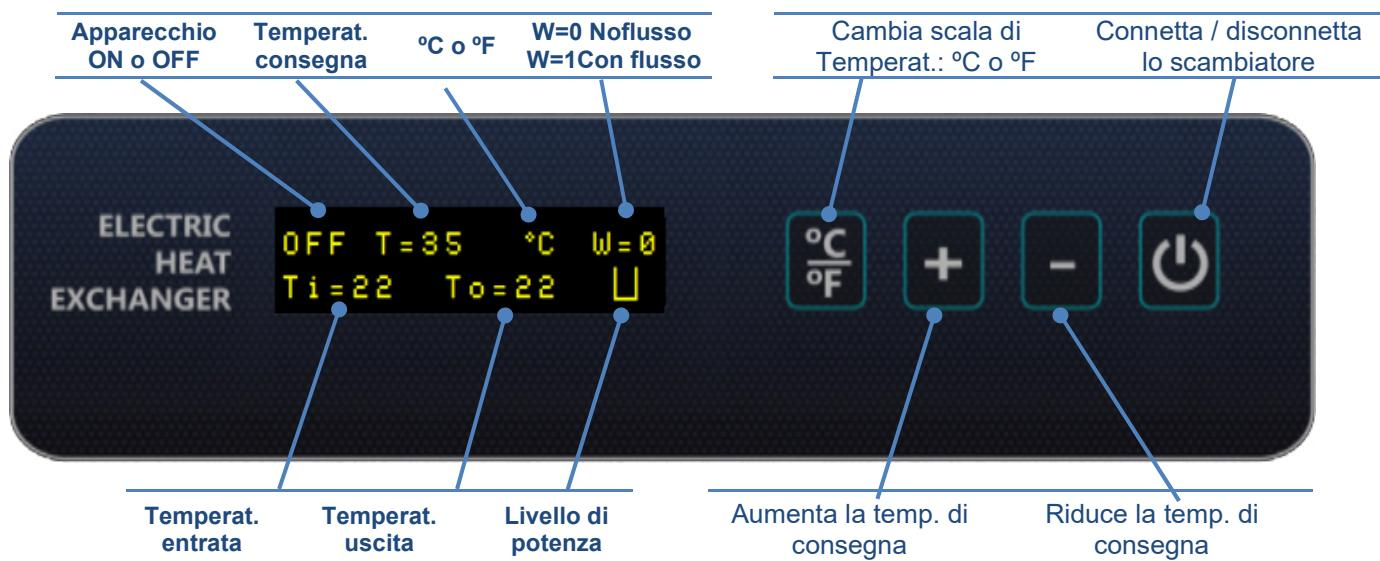
L'apparecchio mostra se sta riscaldando l'acqua mediante una icona nella parte inferiore a destra dello schermo.
