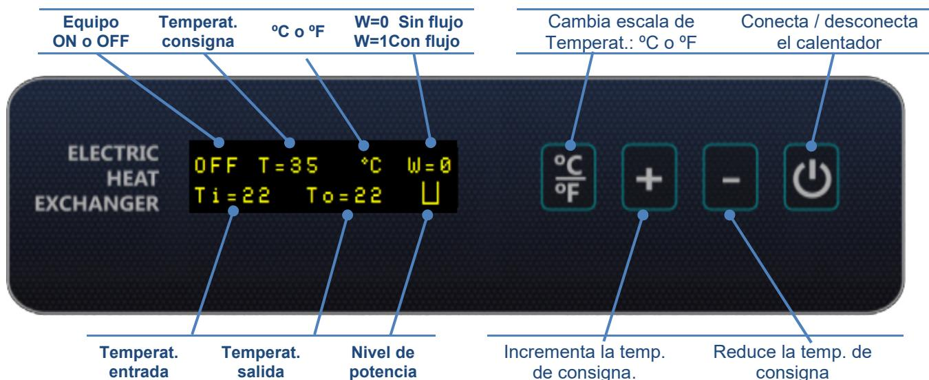
El equipo muestra si está calentando agua mediante un ícono en la parte inferior derecha de la pantalla:
