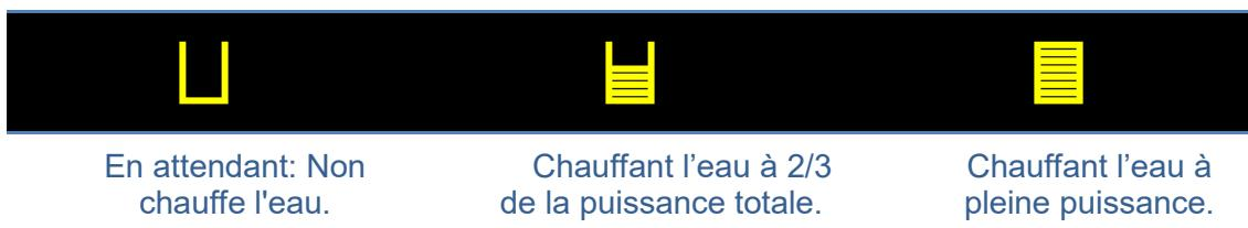
Chauder eau à 2/3 de la puissance totale se réalise pour obtenir un démarrage doux de l'équipement et lorsque la température de l'eau est proche de la température consigne: Arrivée à température consignée doucement.
