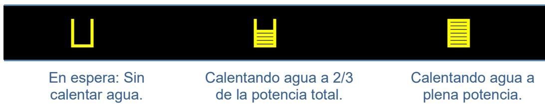
Calentar agua a 2/3 de la potencia total: se produce para realizar arranques suaves del equipo y cuando la temperatura del agua está cerca de la de consigna: llegada a consigna suave.
