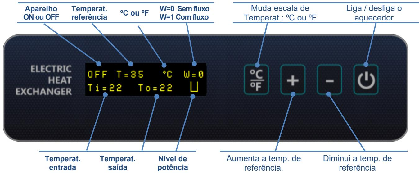
O aparelho mostra se está a aquecer a água através de um ícone na parte inferior direita do ecrã:
