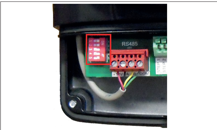
Position der Schalter zur Steuerung über iQPUMP
