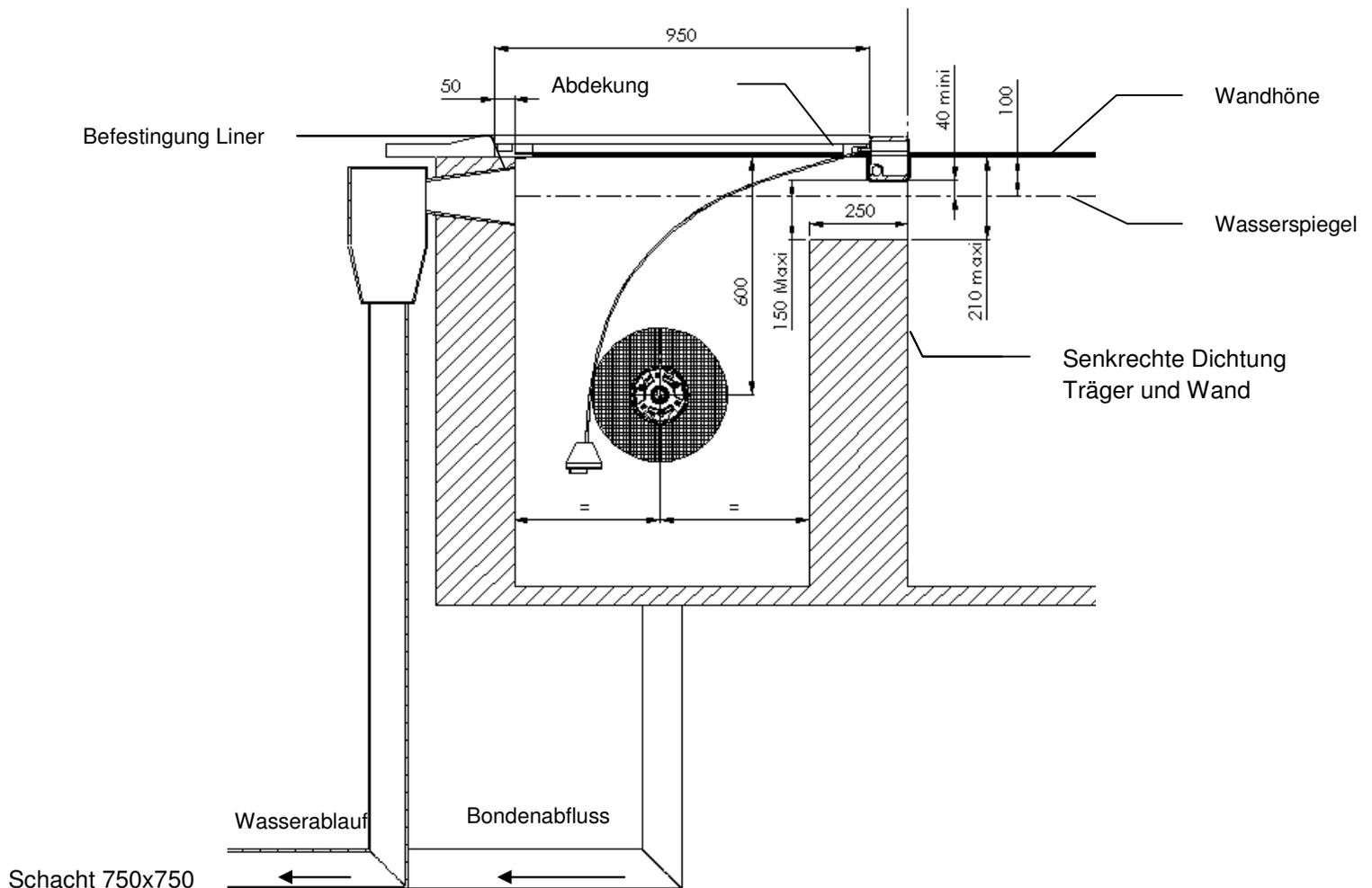
Schacht 750x750 mit Bodenablauf und Belüftung
