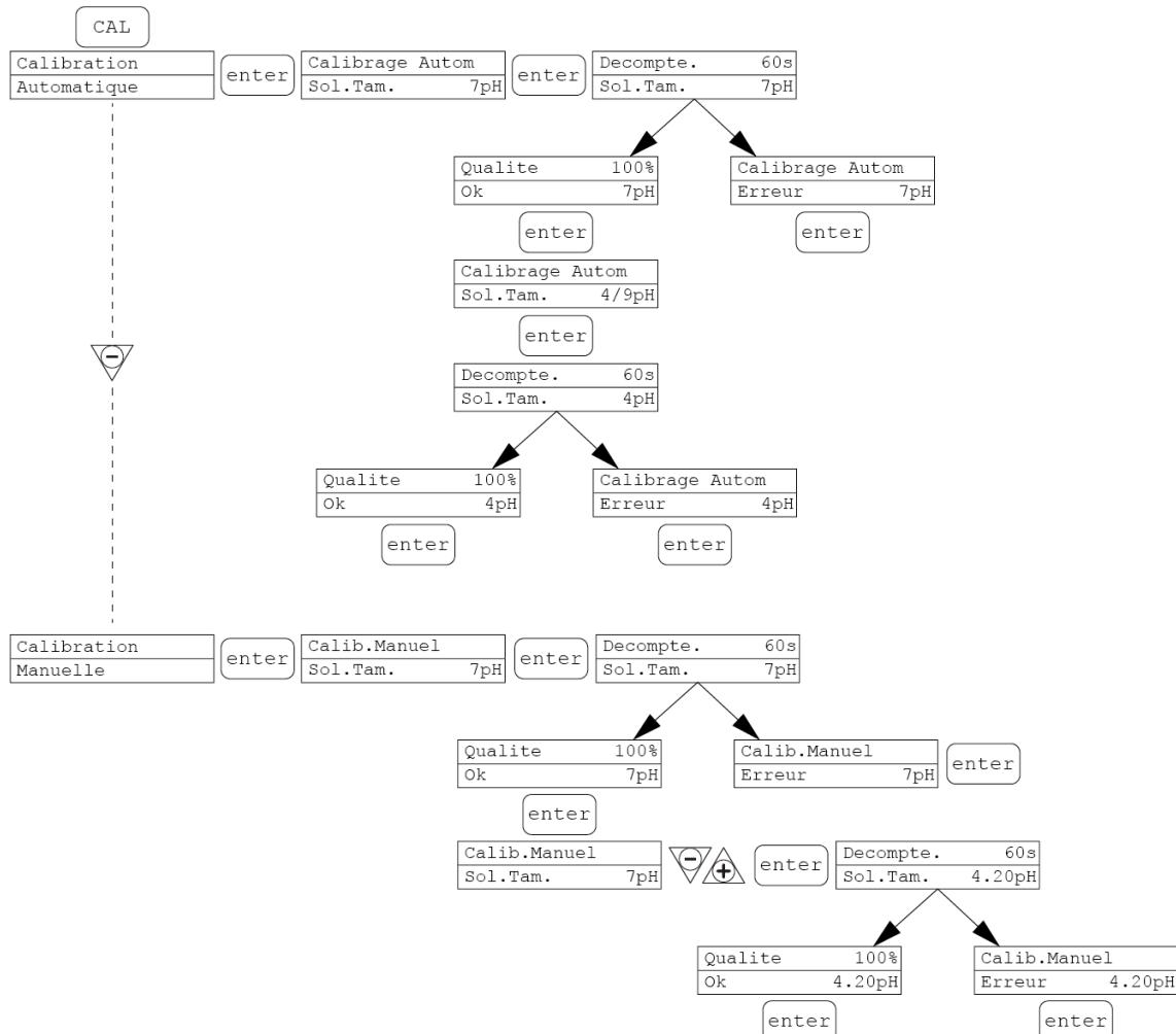
Il est possible de choisir le mode automatique ou manuel, dans les deux cas le calibrage à pH 7 se fait automatiquement.
