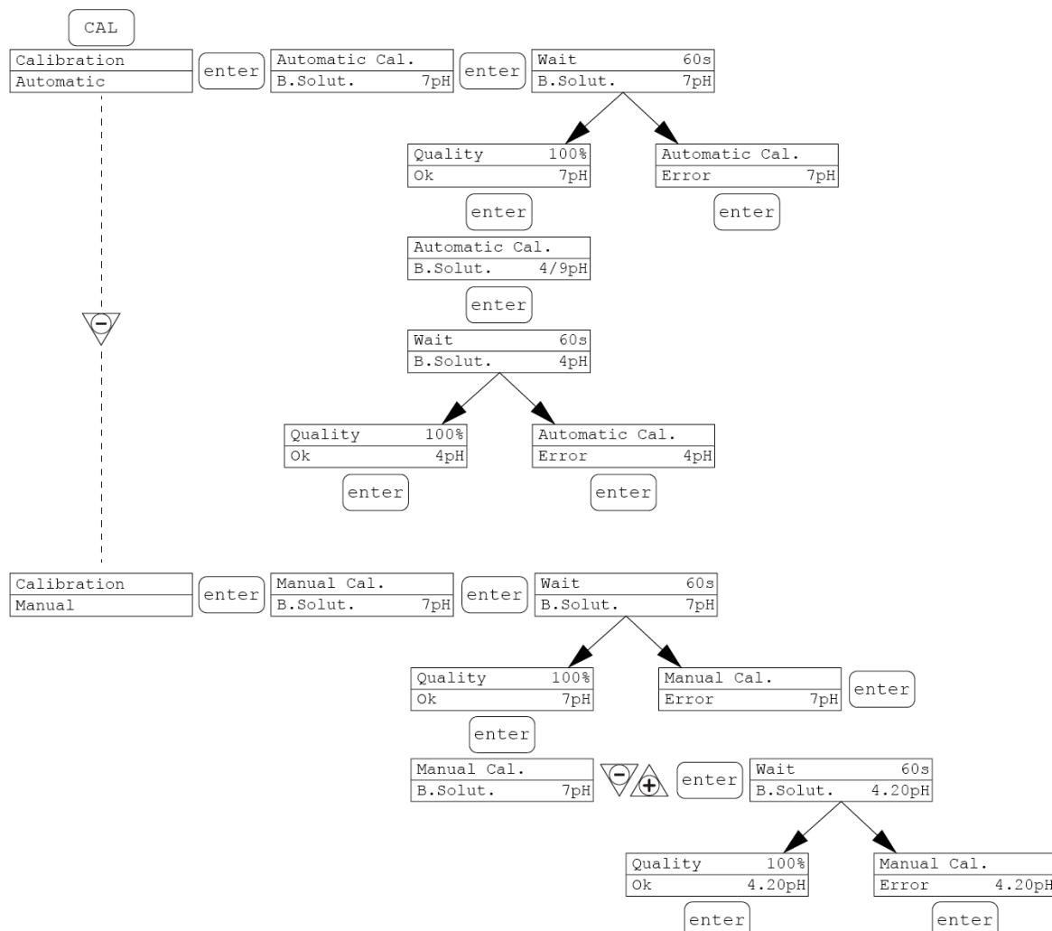
É possível selecionar o modo automático ou manual. Em ambos os casos, é calibrado automaticamente para pH 7.
