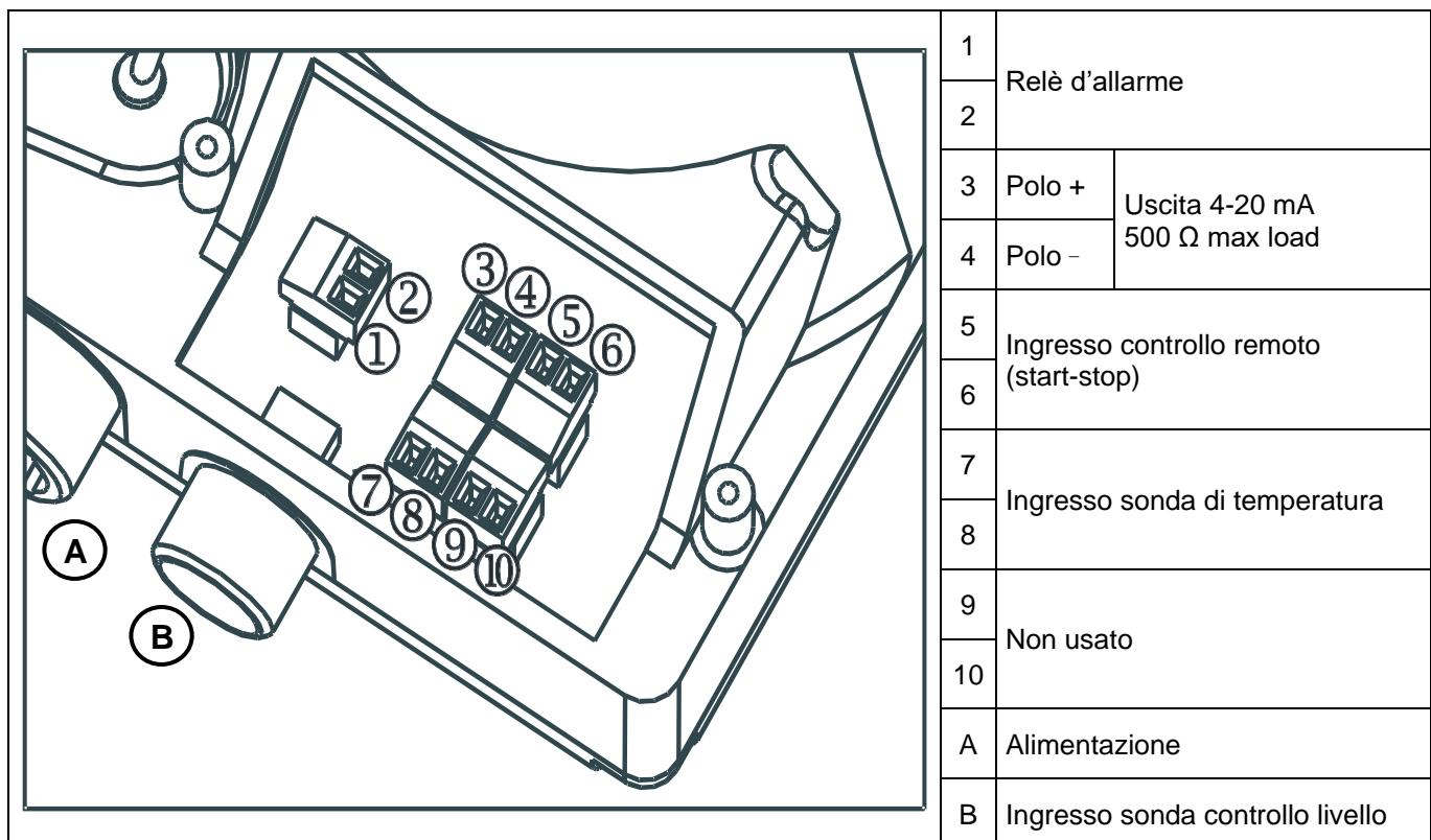
È preferibile evitare che la pompa abbia una sorgente di alimentazione comune con apparecchiature elettriche che generano alte tensioni.
