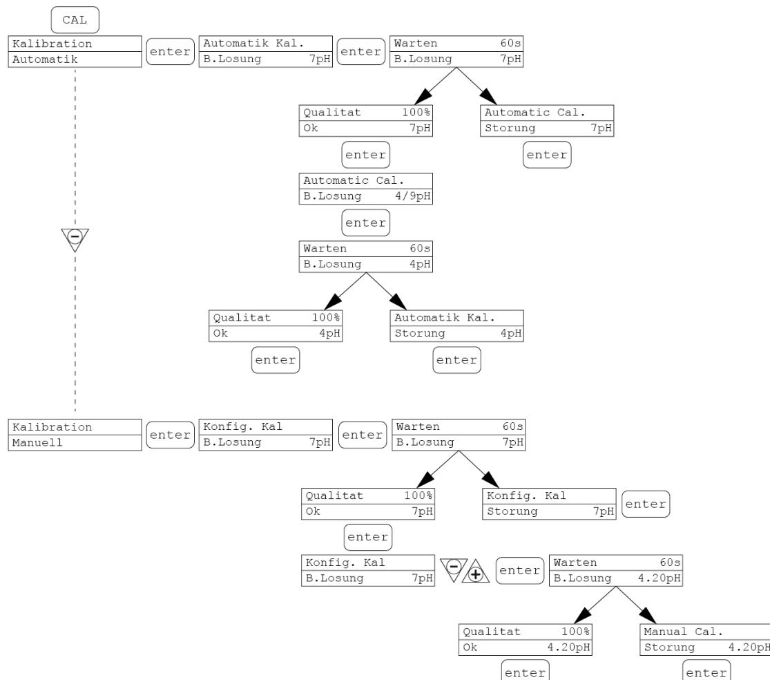
Es ist möglich, die automatische oder die manuelle Kalibrierung zu wählen. In beiden Fällen erfolgt die Kalibrierung auf den pH-Wert 7 automatisch.
