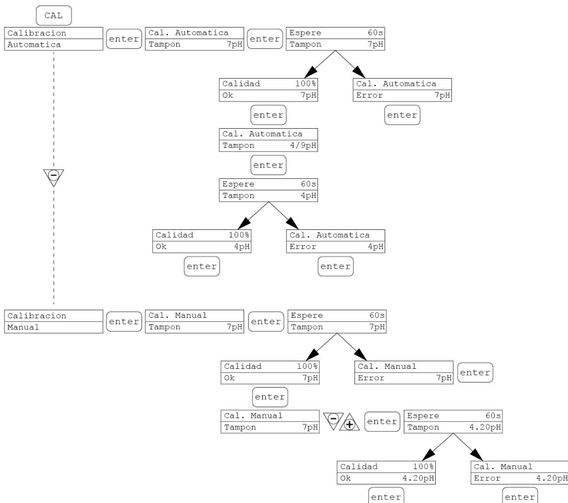
Es posible elegir el modo automático o manual, en ambos casos la calibración con pH 7 se lleva a cabo automáticamente.
