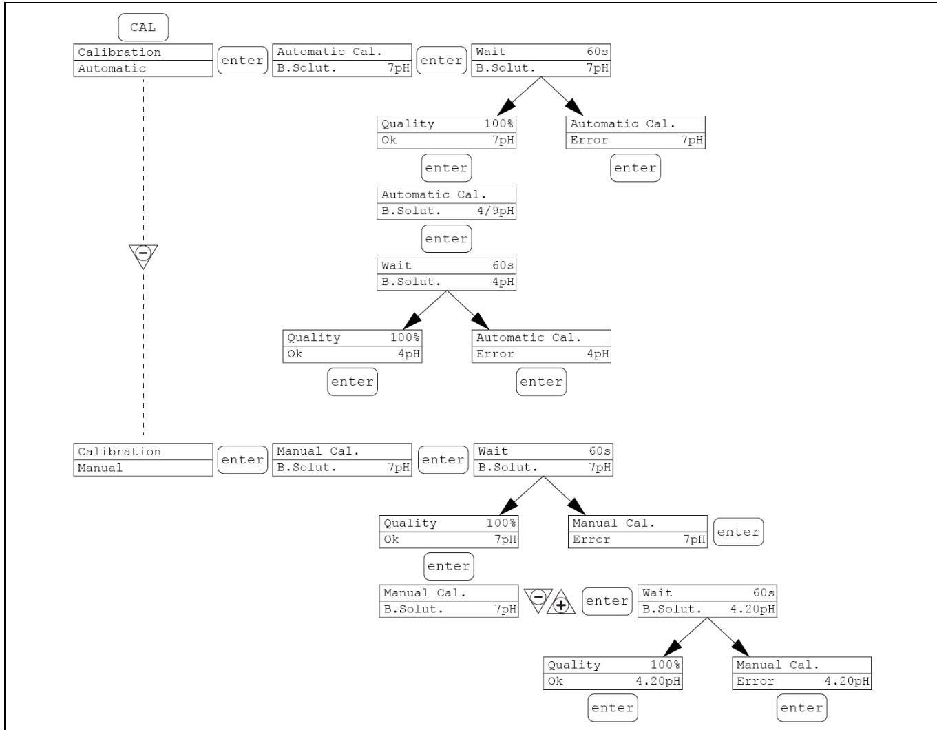
Is het mogelijk om de automatische of handmatige modus te selecteren. In beide gevallen wordt automatisch gekalibreerd op pH 7.
