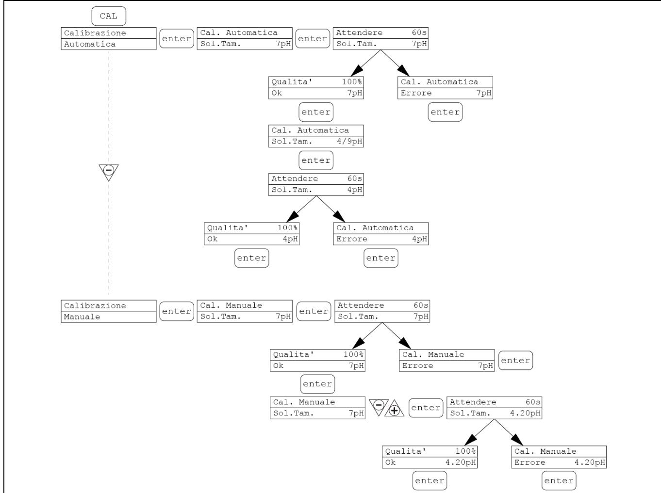
È possibile scegliere la modalità automatica o manuale, in entrambi i casi la calibrazione a pH 7 avviene in automatico.
