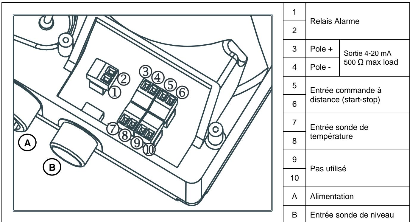
La pompe doit être connectée à une alimentation conforme aux valeurs figurant sur l'étiquette placée sur le côté de la pompe, le non-respect des limites imposées peut endommager la pompe.
