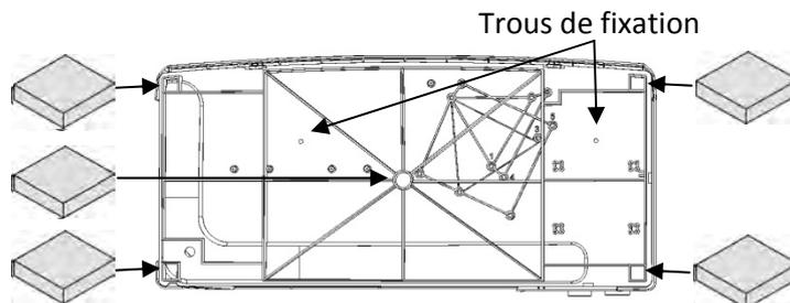
**i** Possibilité de fixer l'appareil au sol, grâce aux trous dans le socle de l'appareil (fixations non fournies). Un schéma de perçage est disponible au dos du carton d'emballage.
