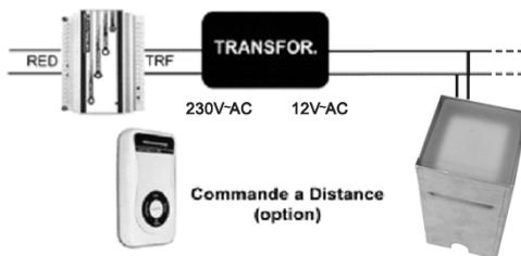
**Chaque Modulateur peut contrôler jusqu'à un maximum de 90 Brick lights à LEDs.**
