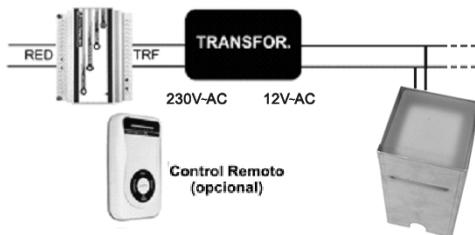
**Cada Modulador puede controlar hasta un máximo de 90 Brick lights de LEDs.**
