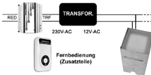
**Jeder Modulator kann bis zu 90 Scheinwerfer mit Leds steuern.**
