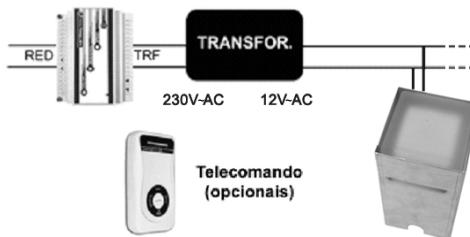
**Cada Modulador pode controlar até no máximo 90 Brick lights de LEDs.**
