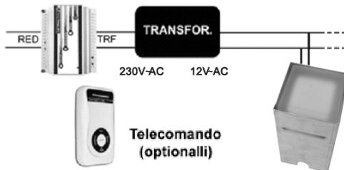
**Ogni Modulatore può controllare fino ad un massimo di 90 faretti a LED.**
