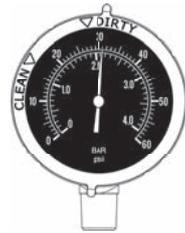
**Posición flecha «DIRTY» = indica que la presión en el filtro ha aumentado respecto a la presión inicial de funcionamiento del filtro y que el cartucho filtrante está sucio.**
