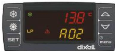
État de fonctionnement : défaut de fonctionnement « Basse pression », Symbole « **Triangle d'avertissement** », « **LP** » et « **A02** » **Eau froide, évaporateur encrassé, manque de réfrigérant**
