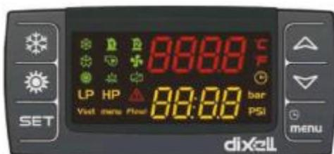
Le fonctionnement du compresseur est indiqué par un symbole de compresseur vert avec le chiffre 1, le fonctionnement de la pompe de filtration par le symbole de pompe vert et le fonctionnement du ventilateur axial par le symbole de ventilateur vert.
