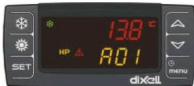
État de fonctionnement : défaut de fonctionnement « Haute pression », Symbole « **Triangle d'avertissement** », « **HP** » et « **A01** » **Manque d'eau, manque d'air**
