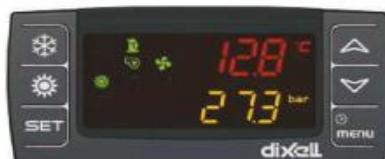
État de fonctionnement : défaut de fonctionnement « Contrôleur de débit », symboles « **Compresseur** », « **Ventilateur** » et « **Pompe de filtration** » **allumés, mais le compresseur et le ventilateur restent éteints ;**
