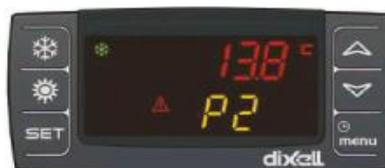
État de fonctionnement : défaut de fonctionnement « Rupture de la sonde Pb2 », symbole « **Triangle d'avertissement** » et « **P2** » **Vérifier la sortie de la sonde de température de l'eau de la piscine**
