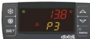
État de fonctionnement : défaut de fonctionnement « Rupture de la sonde Pb3 », symbole « **Triangle d'avertissement** » et « **P3** » **Vérifier la sonde de température de l'évaporateur**
