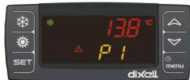
État de fonctionnement : défaut de fonctionnement « Rupture de la sonde Pb1 », symbole « **Triangle d'avertissement** » et « **P1** » **Vérifier l'entrée de la sonde de température de l'eau de la piscine**
