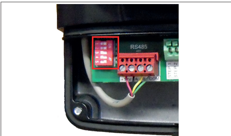
Positie van de switches voor het sturen door de gebruikersinterface
