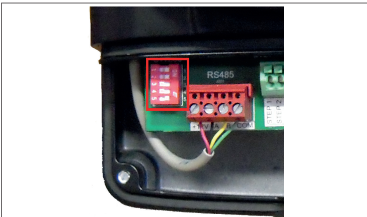
Positie van de switches voor het sturen door iQPUMP
