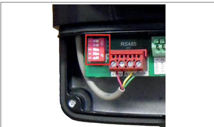
Positie van de switches voor het sturen door AquaLink® TRi
