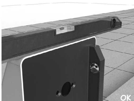
**Attention !** Un forçage des pieds pour les ramener de niveau par les écrous de fixation peut endommager, voire détruire la partie arrière du motoréducteur.
