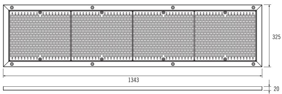
**Reja de aspiración gran caudal hormigón / High flow suction grill concrete** hasta / up to **250 m<sup>3</sup>/h** CÓDIGO / CODE **35371**
