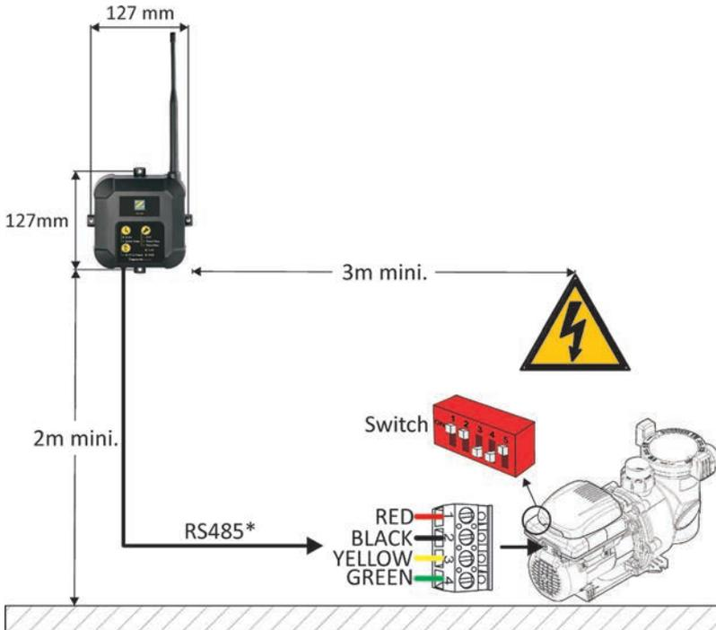
\*NÃO conectar o aparelho a uma fonte de tensão da rede ou de alta tensão; o aparelho funciona a um nível de potência RS485 UNICAMENTE.
