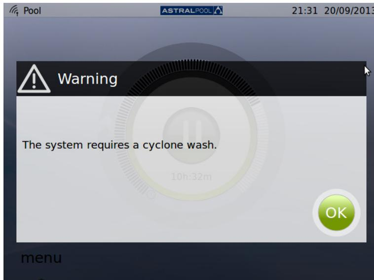
Figura 44: El ciclón necesita una limpieza
