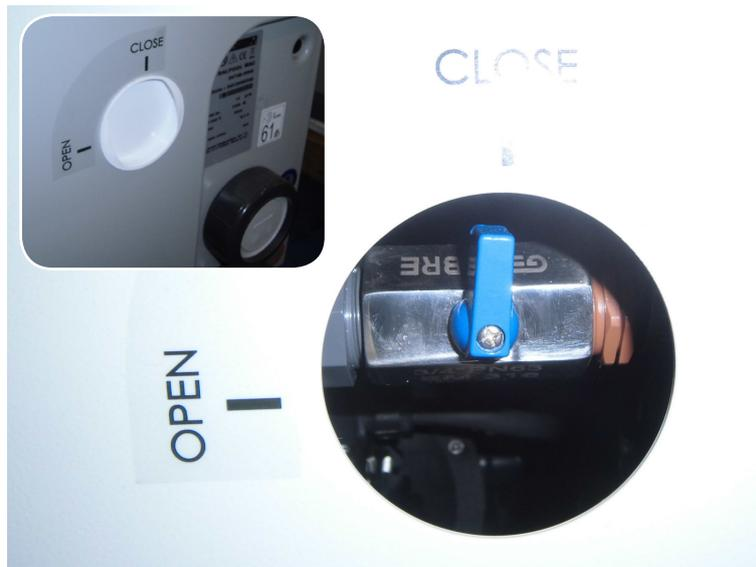
Figura 47: Abrir el tapón y girar la llave hacia la posición abierta ("Open")
