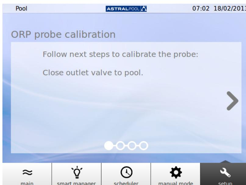
Figura 33: Cierre la válvula de salida a la piscina
