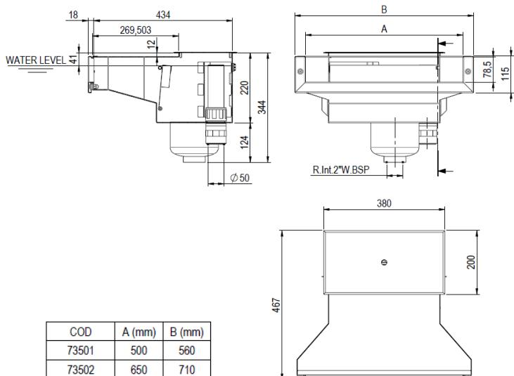
Los skimmers High Level permiten altos niveles de agua en la piscina. La línea de flotación del agua se sitúa muy cerca de la piedra de coronación, creando así un efecto de desbordamiento en la piscina. Fabricados íntegramente en acero inoxidable AISI-316L.
