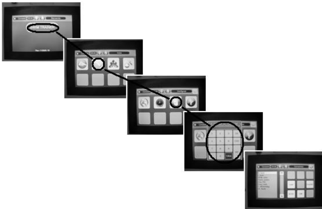
Figura 8.- Secuencia de menús para acceder al menú de programación de los parámetros de la bomba.
