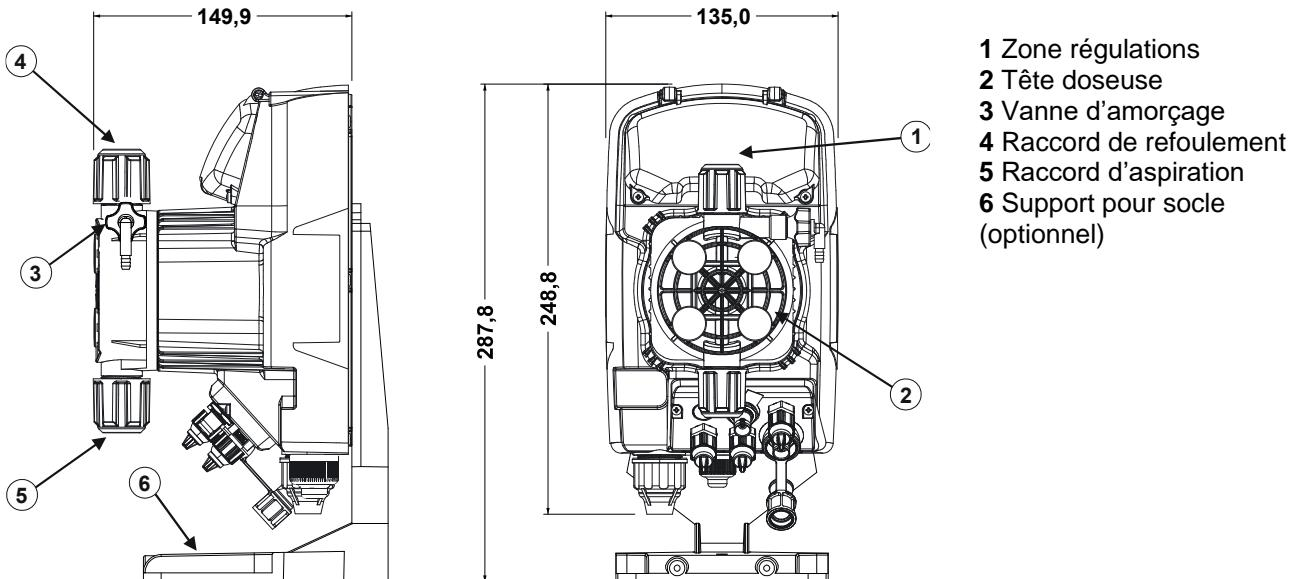
Les parties en contact avec le liquide ont été choisies pour garantir une compatibilité parfaite avec la plupart des produits chimiques normalement utilisés. Compte tenu de la variété de produits chimiques existant sur le marché, il est conseillé de vérifier la compatibilité chimique entre le produit dosé et les matériaux en contact.
