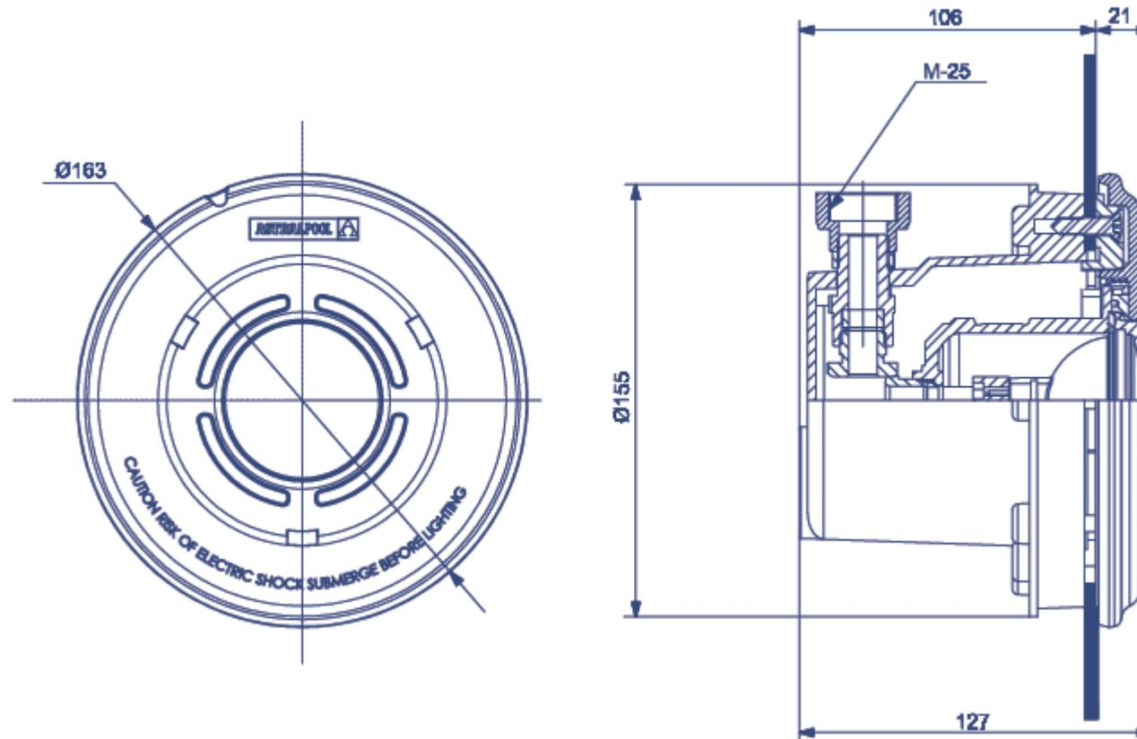
Medidas en mm / Measurements in mm
